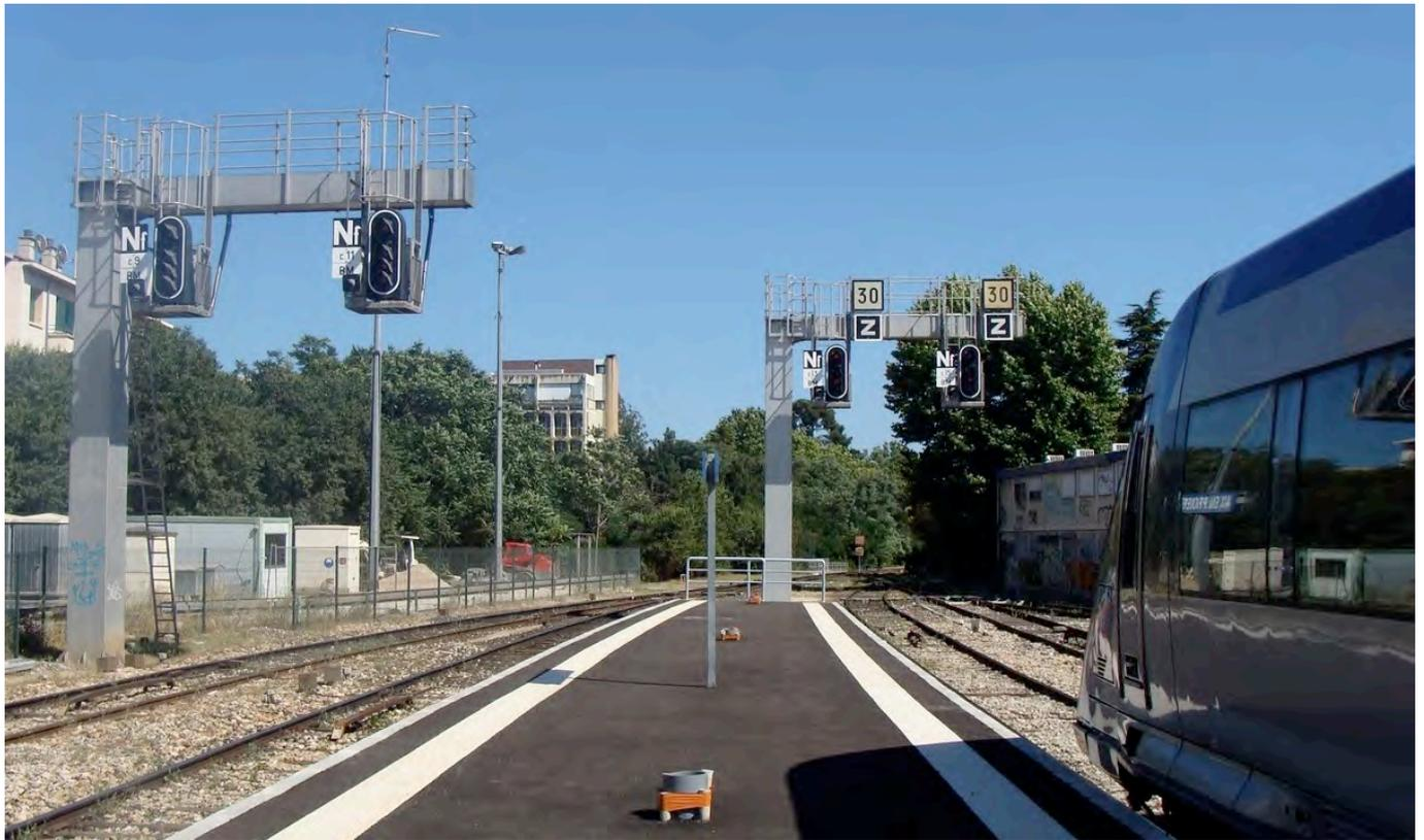
À gauche, aucune limitation, à droite, panneaux Z 30 km/h.
